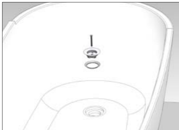
11 - Fissare la ghiera alla piletta mediante l'apposita vite; stringere fino a schiacciare la guarnizione. 11 - Fit the ring nut to the drain by the screw included in the packing; tighten the screw until the gasket is compressed.
